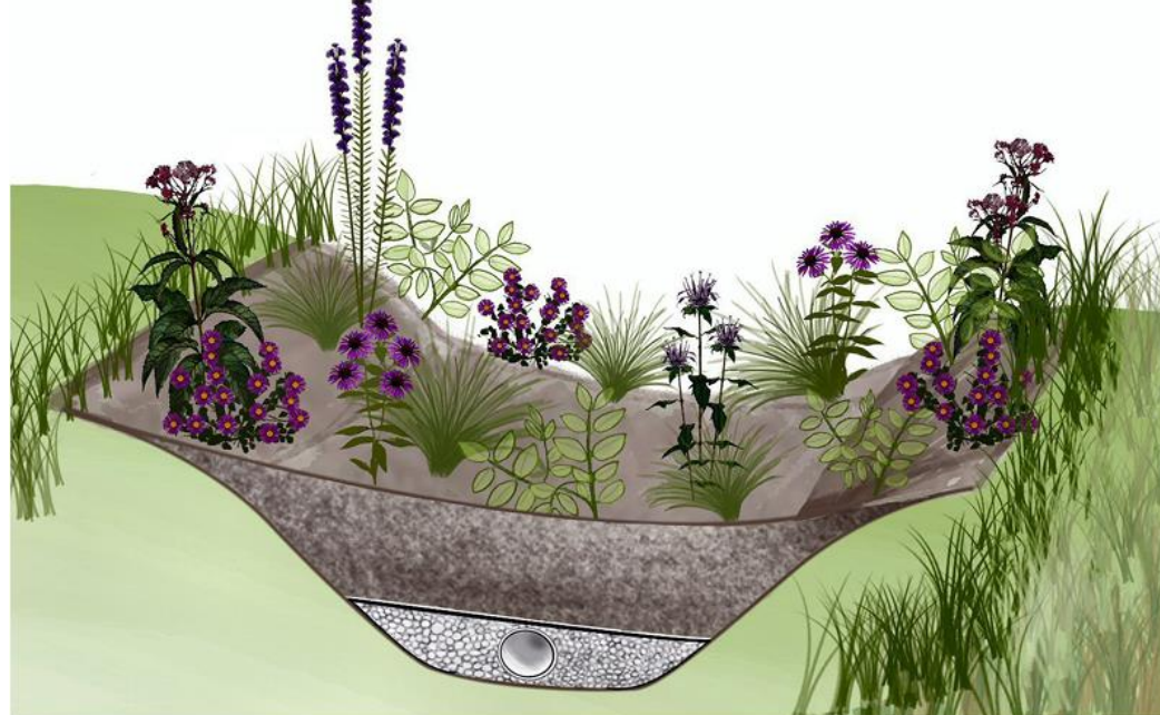
Schéma d'un jardin de pluie en coupe
